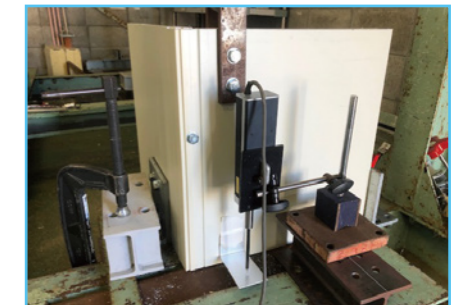
●天井 - 壁嵌合部強度試験
