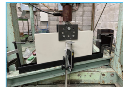
●ベース - 壁固定部強度試験
