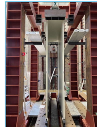
●パネル壁部分試験
