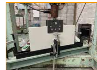
●ベース - 壁固定部強度試験
