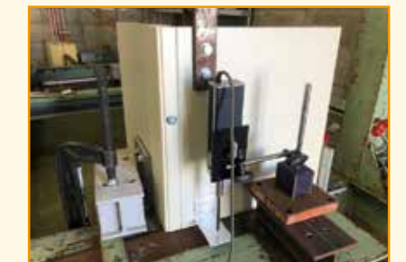
●天井 - 壁嵌合部強度試験
