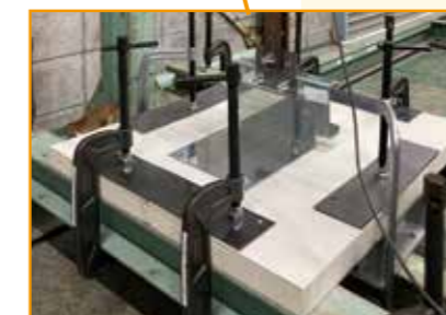
●胴縁固定部強度試験
