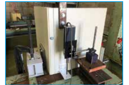
●天井 - 壁嵌合部強度試験
