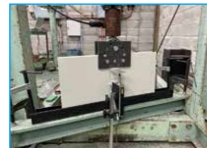
●ベース - 壁固定部強度試験
