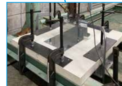
●銅線固定部強度試験
