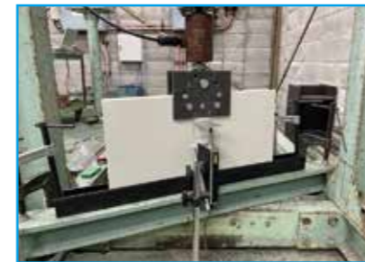
●ベース - 壁固定部強度試験
