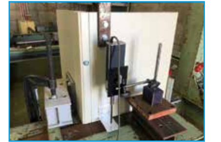
●天井 - 壁嵌合部強度試験
